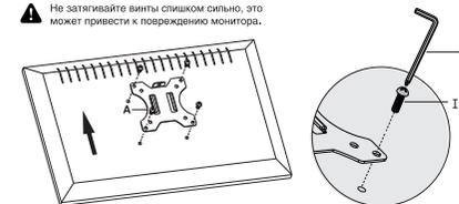
ВАРИАНТ В: Монитор с изогнутой задней панелью
